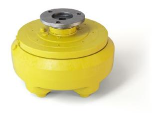
Cabezales planetarios con 5 ó 6 herramientas planetarias para nivelar y lijar losas de granito, gres porcelánico, cerámica y cuarzo. Los cabezales planetarios se utilizan en las primeras 1 ó 2 posiciones de las pulidoras para aplanar el material y hacerlo uniforme. De este modo, los cabezales tangenciales instalados inmediatamente después proporcionan un mejor resultado de pulido haciendo que el proceso sea más eficiente.
